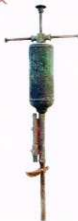
Fig. 18 : Injecteur à sulfure de carbone (coll. M. Labbé).
