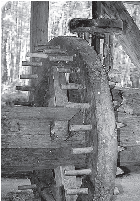
Fig. 5 : Rouet et lanterne du moulin de Guédelon (© Denis Gliksman, INRAP) 16 .
